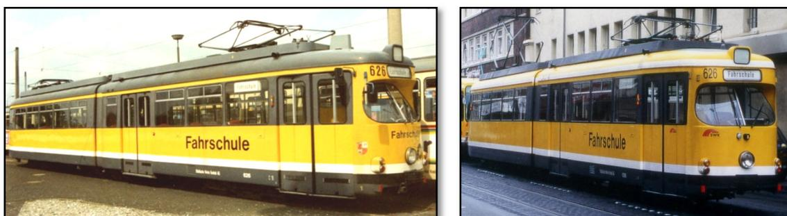
Aus den A-Teilen der Triebwagen 602 und 606 entstand 1984 der Fahrschul-Triebwagen 626. Er wurde auch als Schlepp-Triebwagen für liegengebliebene Straßenbahnfahrzeuge und für andere Werkstattzwecke genutzt. Im Rahmen einer Hauptuntersuchung erhielt er 1992 eine geänderte Lackierung des Dachbereiches.
