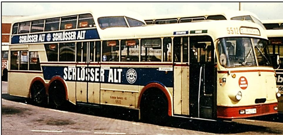
An diesen Aufnahmen desselben Omnibusses sieht man den Übergang vom Schaffnerbetrieb (Fahrgastfluss von hinten nach vorne) zum Einmannbetrieb mit Einstieg beim Fahrer. Auf die Türe im Heckbereich konnte verzichtet werden, allerdings musste die Vordertüre breiter ausfallen (Barzahler rechts/Sichtkarten links).
