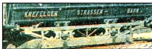
links *Fahrgestell der Bauart "Union", links im Originalaussehen (Tw 68)*
