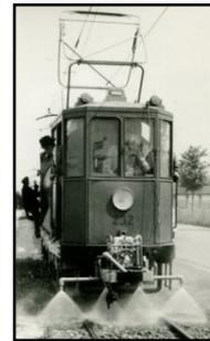
Sprengwagen 232 II, vorher 181 in der Ursprungsversion als Vierachser und mit neuer Sprühvorrichtung zur Bekämpfung von Unkraut im Bereich eigener Bahnkörper ("Schottergleis")
